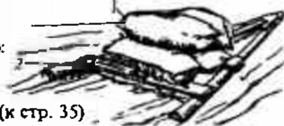
К рис. 286. Плавающая мина (заряд ВВ в мешках на деревянном \Delta -образном плотике); 1-заряд ВВ, 2- плотик
