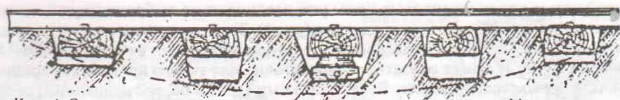
К рис. 6. Схема подкопа соседних шпал при установке мины
