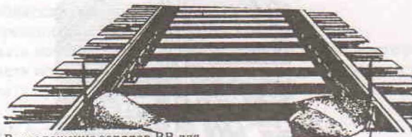
Расположение зарядов ВВ для перебивания рельсов (заряды присыпаны грунтом)
