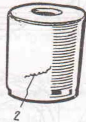
К рис. 10 Повреждения подшипников качения: 1 — скол на ролике; 2 — след ожога ролика электротоком; 3 — ползуны (лыски) на роликах; 4 — продольный задир ролика; 5 — усталостное выкрашивание на дорожке качения внутреннего кольца
