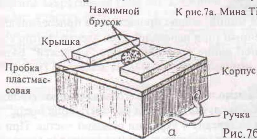
Рис. 7б а-общий вид ; б-разрез К рис. 7б. Мина ТМД-44
