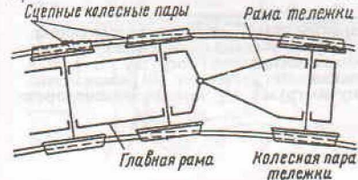
К рис.14. Схема прохождения кривой экипажем паровоза и тележкой
